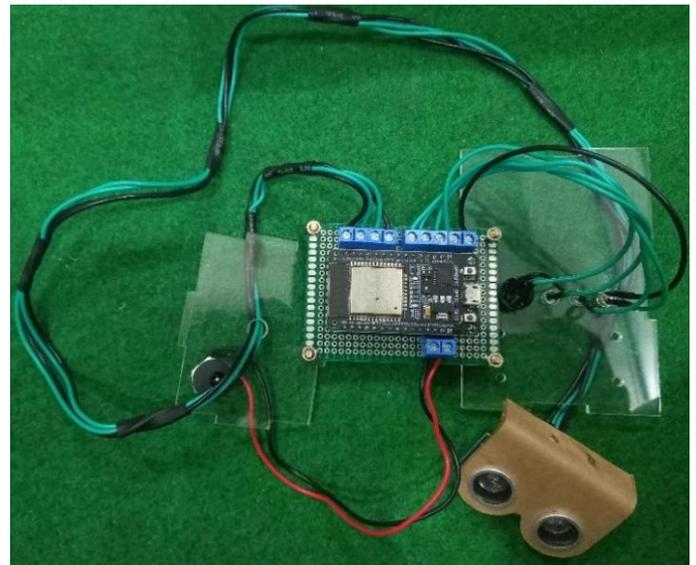
Gambar 7. Rangkaian koneksi pada ESP32
