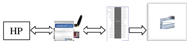
Gambar 3.20 Kode digunakan untuk menggerakkan motor pintu air2.
